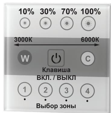
**Кнопка ВКЛ. / ВЫКЛ** - включение/выключение панели;
