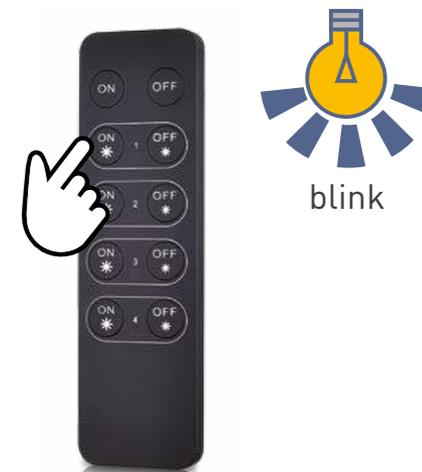
А теперь нажмите соответствующую кнопку зоны на пульте. Свет моргнет один раз – привязка прошла успешно.
